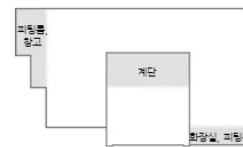
매스의 계단 부분은 서브공간으로 주로 직원이 사용하는 공간이다. 서브 공간은 창고, 소원도, 피팅룸, 계단으로 부가적인 부분이 포함된다. 계단을 과거 공간에 배치함으로써 고객이 필수적으로 과거의 공간을 지나가도록 했다.
